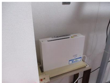
移動型オゾン脱臭装置
